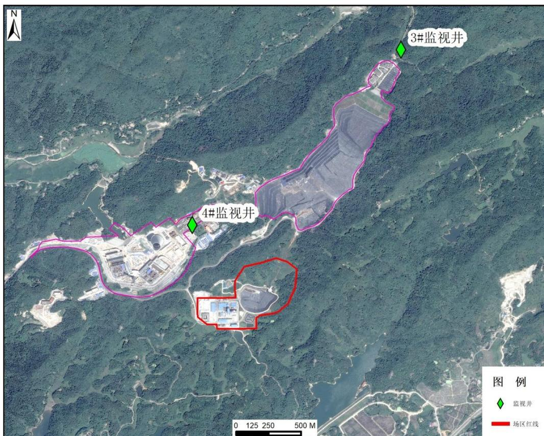
图 6.5-4 分水岭附近监测井与填埋场位置关系示意图
